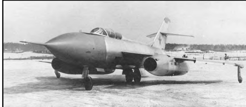
Yak-27 (121) à moteur RD-9AK de 1956 : radar et missiles K-7 (OKB-134), K-8 (OKB-4) et K-9 (KB-1+OKB-134)
